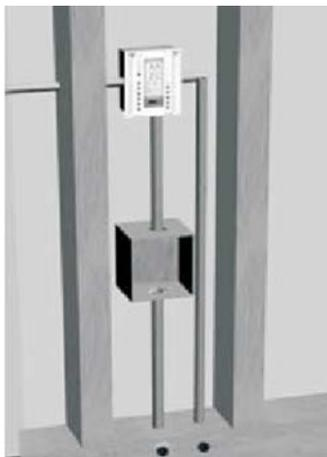
4. Подсоедините датчик температуры пола к терморегулятору через кабельный канал и установите его между двумя греющими полосами на расстоянии не менее 50см от стены.
